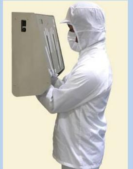
除菌中は指を開いて静止します。規定時間が経過すると、音と表示で除菌終了をお知らせし、同時に紫外線照射が止まります。
